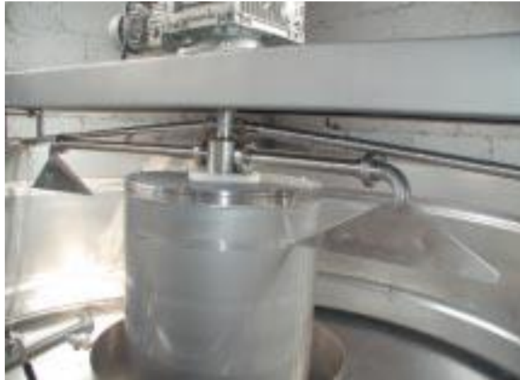
Şəkil 1.12. Flotator qurğusunun yuxarıdan görünüşü
